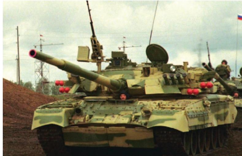
Un T 80 UM-2 dotato di sistema di protezione attiva di prima generazione DROZD 1 ripresa nel 1998. Notare i lanciatori dei razzi destinati a intercettare i missili anticarro in avvicinamento.
