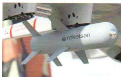
Una MAM-L agganciata al pilone alare di un drone Bayraktar
