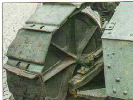
Dettaglio di un cingolo di carro Renault FT del 1917; si noti come l'articolazione dei pattini permetta che questi si adattino al profilo circolare della grossa ruota di rinvio anteriore. Come in molti carri di inizio Novecento, pur essendo prevista la retromarcia, la conformazione delle maglie e lo specifico verso del cingolo (non montabile al contrario) furono pensati per agevolare solo il moto in avanti su terreni difficili.
