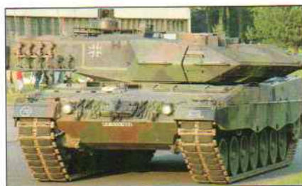
Un moderno cingolo, quello montato su un carro Leopard 2A6 tedesco. Si notano i tasselli in gomma scheggiati e consumati.
