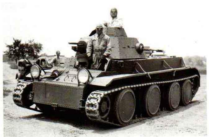
Il progettista statunitense Walter Christie aveva ideato un carro armato "convertibile" (qui uno dei vari modelli fotografato durante alcune prove nel 1936). Infatti, aveva la possibilità di marciare ad alta velocità su strada e terreno compatto; ciò si otteneva rimuovendo i cingoli e avvalendosi delle ruote gommate e dotate di battistrada, come se si trattasse di un normale autoveicolo; la sterzata avveniva grazie ai primi rulli portanti direzionabili. Le corregge sul parafrangente servivano ad assicurare il cingolo quando veniva rimosso. (Library of Congress)
